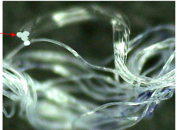
化學力侵蝕之斷絲斷面 (本所基本資料 SEM 照片)
